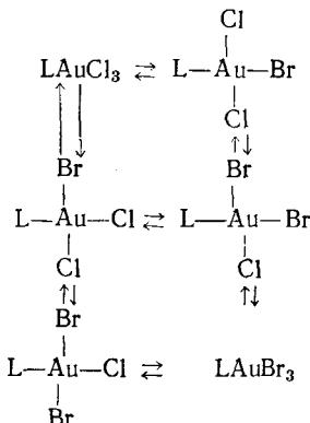
Отклонение от статистического распределения атомов галогенов в этой реакции наблюдается лишь для комплексов с большим количеством брома —  $\text{LAuClBr}_2$  и  $\text{LAuBr}_3$  [8]. Поведение одновалентного золота в этой реакции имеет аналогию с поведением изоэлектронных им комплексов Pt(II), для которых также наблюдается статистическое распределение атомов галогенов в комплексах  $\text{Br}_a\text{Cl}_{4-a}\text{PtL}_2$  [9].
